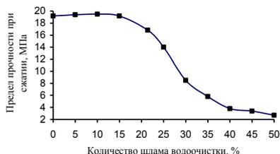
Рис. 11. Зависимость прочности образцов от количества добавленного шлама
