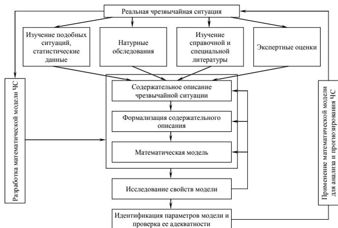
Рисунок 1. Схема построения математической модели
